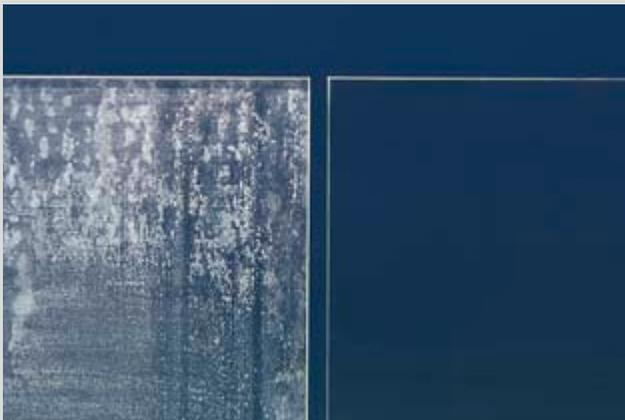
Das korrosionsbeständige vetroShower bleibt über die gesamte Lebensdauer des Produktes klar und beständig. Das haben Langzeittests unter extremen Temperatur- und Hochfeuchtebedingungen mit vetroShower im Vergleich zu herkömmlichem Glas gezeigt.
